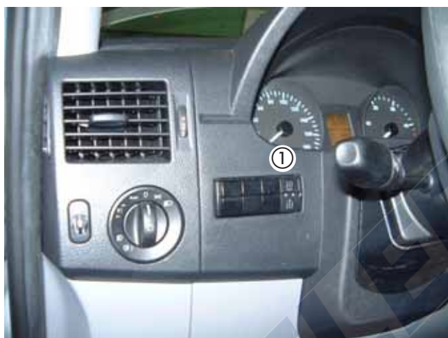
① MB -Taster für Standheiz- und Zuheizfunktion MB button for pre-heater and auxiliary heater function
