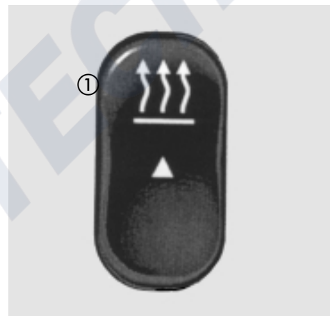
① Schalter Zusatzheizung
